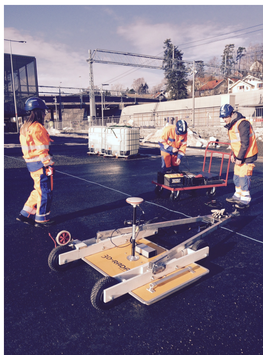
Figure 4.3: Oppsett av utstyr i felt. Her er antennen med GPS-mottaker, koblet til bilbatteri, GeoScope og PC med GeoScope Control
