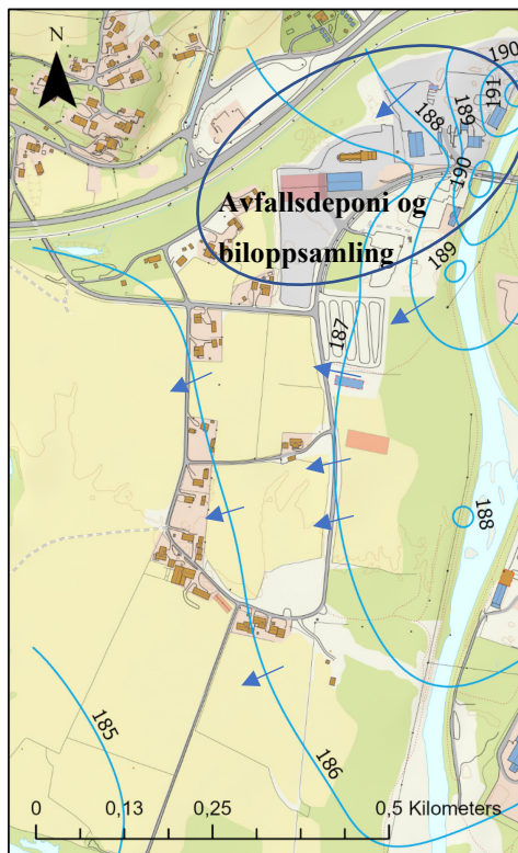
Figur 85: Spredningsveier for forurensning på vest-siden av elva Frya, piler indikerer strømningsretning. Øverst er avfallsdeponiet og biloppsamlingen markert.
