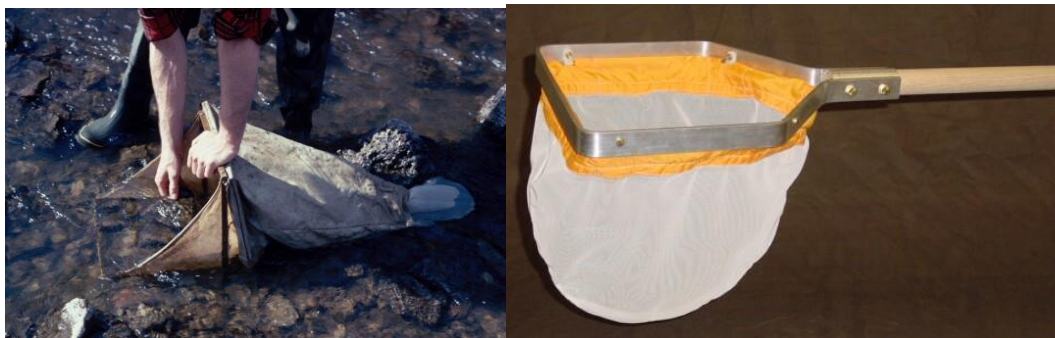
Bilde 3. Surbersamplers og sparkehåv finnes i flere utgaver. Prinsippet er det samme: Med sparkehåven rygger man motstrøms og sparker opp bunnen slik at håven siler substrat og organismer som virvles opp. Surberen skal samle organismene som finnes innen et kjent areal, definert av bunnrammen.
