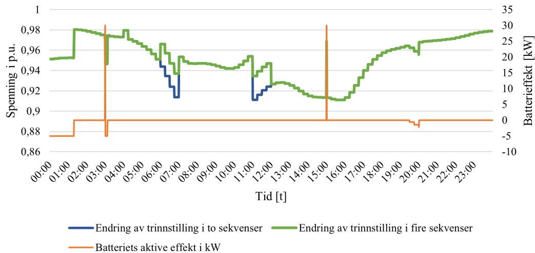
Figur 10.6: Spenning og batterieffekt over det gjeldende døgnet når transformatoren trinnes og batteriet er tilkoblet.
