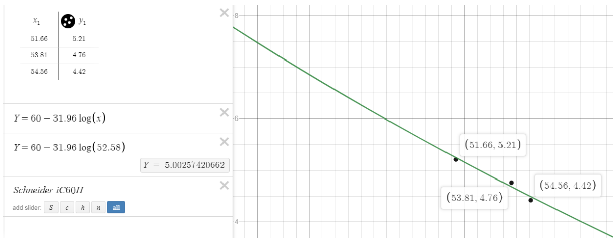
Figur 54: Estimering av utkoblingskarakteristikken til Schneider iC60H 16 A
