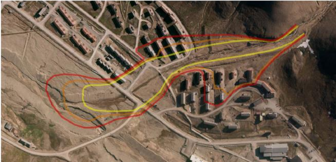
Figur 3: Faresonekart for sørpeskred fra Vannledningsdalen slik situasjonen ser ut uten ytterligere sikringstiltak. Rød linje markerer ytterkanten av faresonen for skred med gjentakintervall på 5000 år, oransje linje markerer det samme for 1000 år, og gul for 333 år. Figuren er hentet fra Jonsson et. al. (2015).
