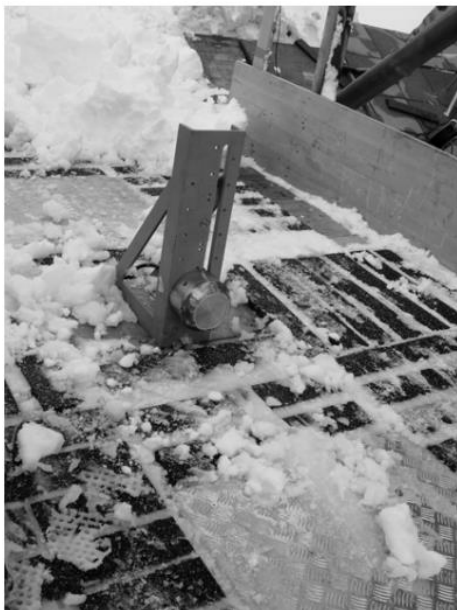
Figur 39: Foto av søyla belastningen fra sørpeskredene ble målt på, hvor lastcella sees nær bunnen av søyla. Bildet er hentet fra Jaedicke et al. (2008).
