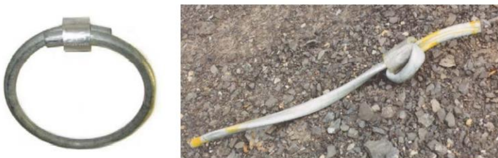
Figur 15: Venstre: ubrukt bremseelement før installasjon. Høyre: tilsvarende bremseelement etter belastning. Røret ringen er laget av har da sklidd gjennom klemma, slik at det har oppstått plastisk deformasjon av vaieren og røret. Begge bildene er hentet fra Wendeler (2016).
