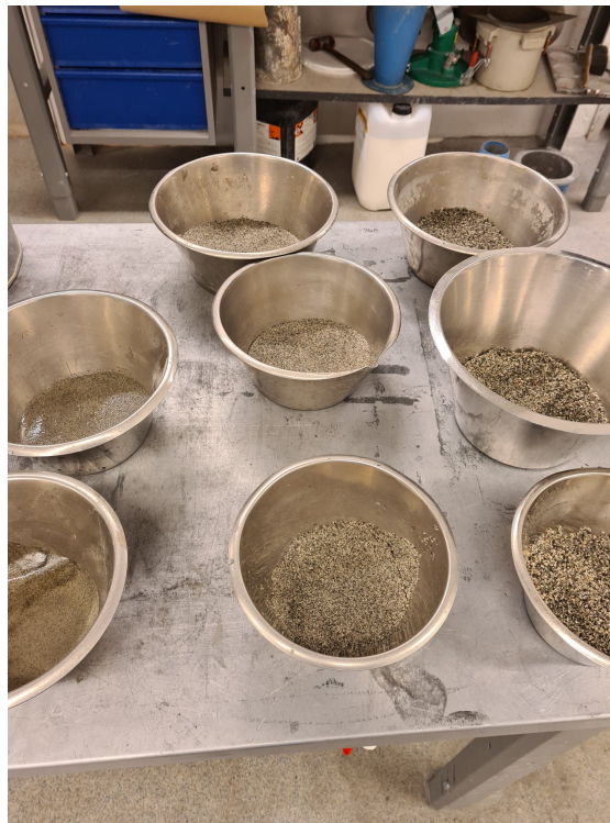
Bilde 6.2.3: Fra måling av biokullets siktekurve. Her vises de ulike fraksjonene etter at de er siktet.
