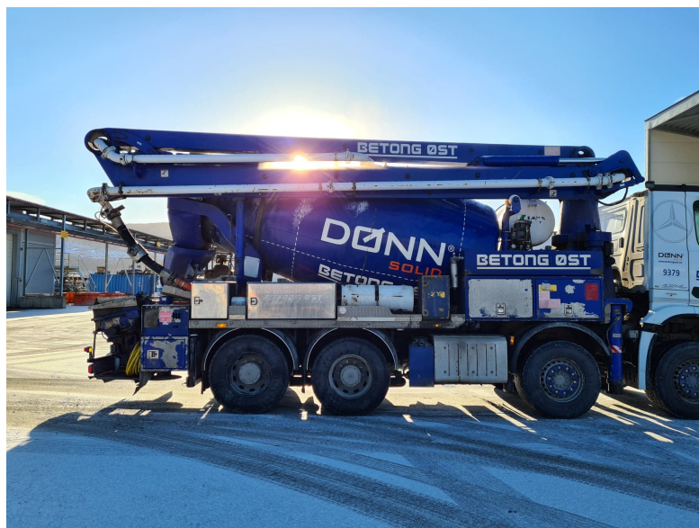
Bilde 3.3.3: Pumpemikser brukt til veggstøp hos Betong Øst.
