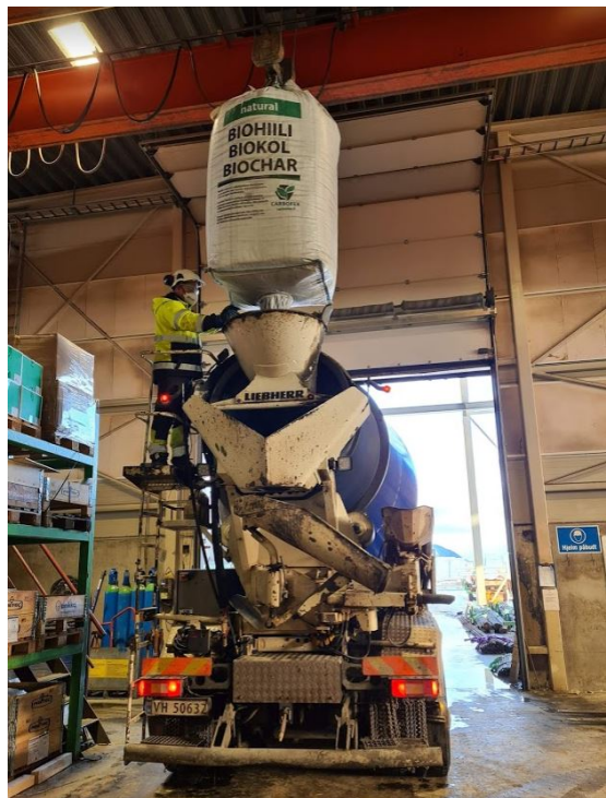
Bilde 11.1.1: Bildet viser en sekk med biokull som er løftet opp før innholdet slippes ned i betongbilen.
