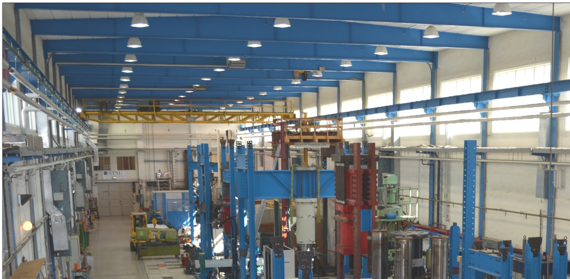
Figur 3.5 – Her kan vi se bjelker med avtagende tverrsnittshøyde bli tatt i bruk på materialteknisk laboratorium på Gløshaugen. Foto: NTNU 2
