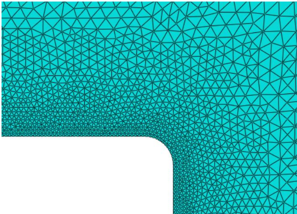
Figur 4.20: Ytterligere forstørret mesh rundt hjørnet øverst til høyre.
