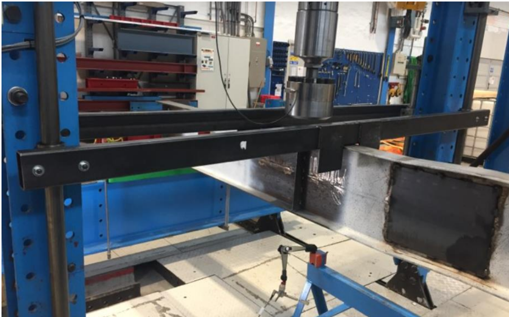
Figur 4.7: Fastholding mot vipping i feltmidte. Til høyre på bildet ser man at åpningen fra tidligere forsøk er lappet igjen.
