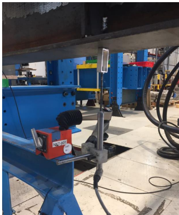
Figur 4.10: I underkant av bjelken ble det festet en LVDT for å logge en mer nøyaktig forskyvning av bjelkene i feltmidte.
