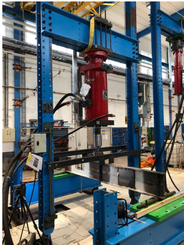
Figur 4.21: Testtriggen er bygget opp av søyler og bjelker boltet sammen. Under belastning fra jekken vil disse deformeres.
