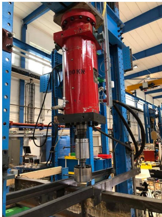
Figur 4.8: Jekken som ble benyttet til å påføre lasten på bjelkene.
