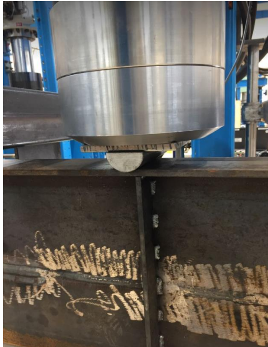
Figur 4.9: Belastningen fra jekken ble fordelt over stiveren i feltmidte ved hjelp av en halv stålsylinder.
