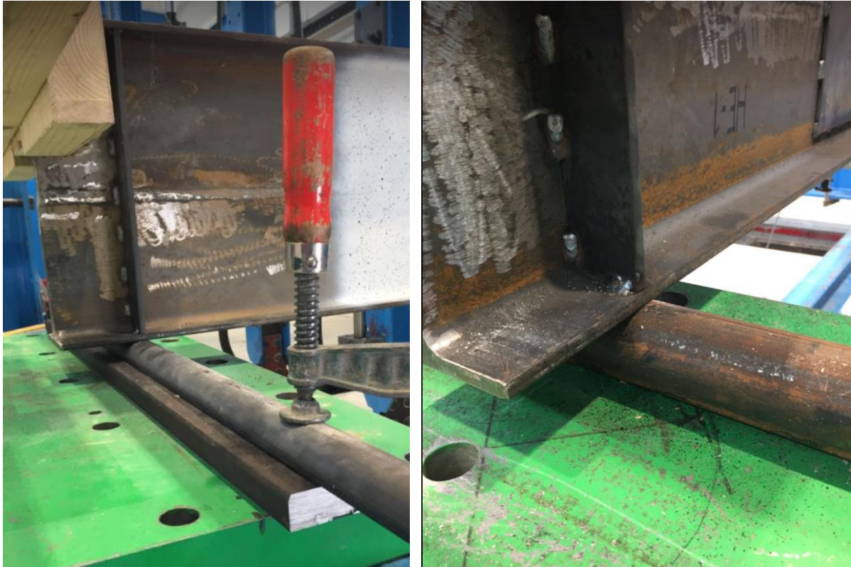
Figur 4.5: Oppleggene til bjelkene i forsøket. Ene enden ligger på et stålrør, og det tillates dermed at bjelken kan forskyve seg i lengderetning.
