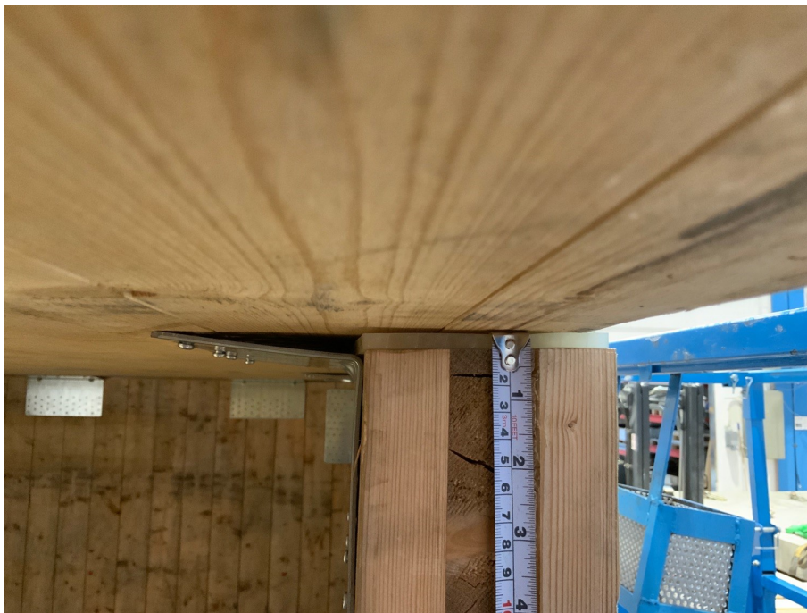
Figur 4.21: TTN-forbindelsen i spenn. Det kan ses såvidt på bilde at det er en glippe mellom xylofonen og taket som var tilfellet ved de første rundene. Xylofonen er her ikke komprimert.
