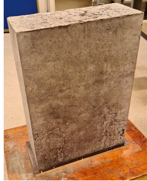
(b) Ferdig støpt veggelement med biokullstaver.
