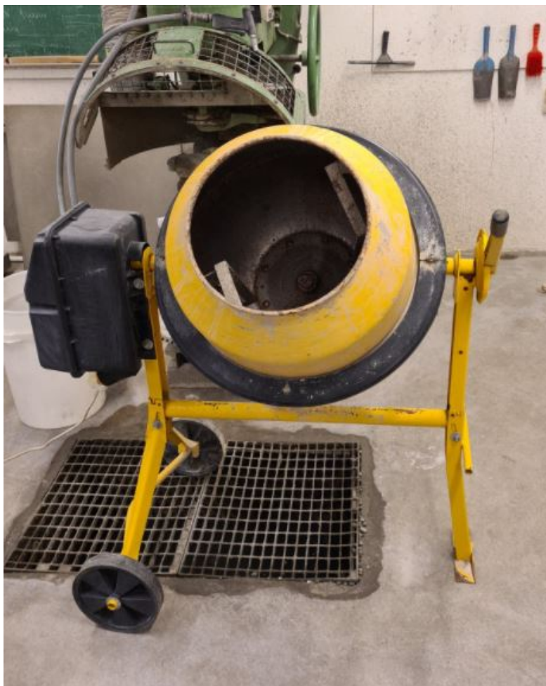
Bilde 6.1.3: Fallblander brukt til å blande sementlimet med biokull.
