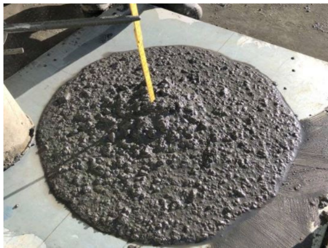
Bilde 13.5.2: Slumptest av betongen brukt til støp av andre vange, Vange-Op63. Betongen har en opphøyning på midten, men flyter ellers godt.
