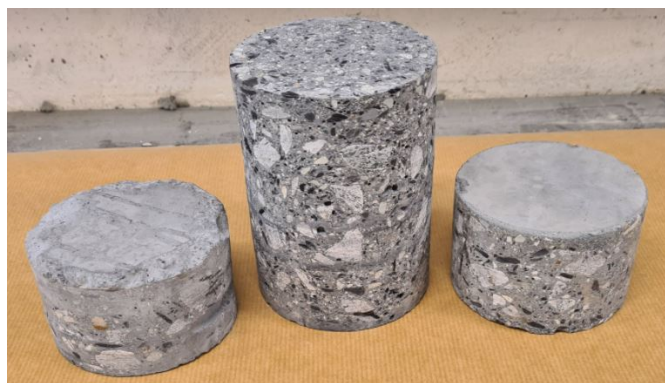
Bilde 11.6.2: Bildet viser ett av prøvestykkene boret ut av veggelementet. De to korteste delene er de to vangene, mens det høye sylindret i midten består av senterbetongen.
