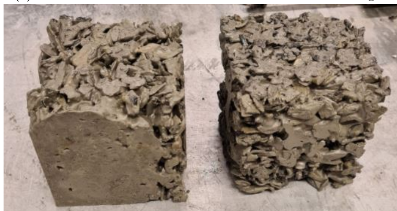
(b) Bildet viser to terninger fra andre blanding av biokullstaver. Her ser man en ansamling av sementlim på den ene terningen.
