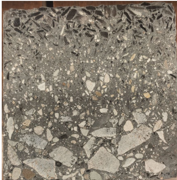
Bilde 13.3.1: Snitt av en terning støpt under fullskalaproduksjon. Betongen har helt tydelig separert seg i denne terningen. Her har de største fraksjonene sunket til bunnen av terningen, mens finere fraksjoner og biokullet har lagt seg oppå. Denne terningen er fra Senter-Op90-nr.1.
