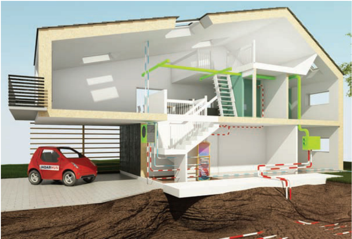
Figur 30: Skisse som viser de tekniske anleggene i ISOBO Aktiv (Jadarhus 2011)
