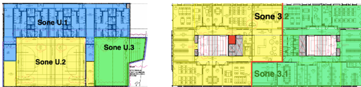
Figur 4.2: Soneinndelingen for underetasje og 3.etasje, (Veidekke) 13 .
