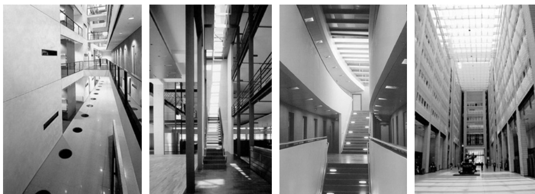
Figur 15. Eksempler på rom over flere etasjer som fungerer utmerket både som føringsvei for avtrekksluft og "skorstein for termisk oppdrift" (motor). Tax office (1996) i Enschede, Nederland (lengst til venstre), Pihl & Søn hovedkontor (1994) i Lyngby, Danmark (venstre), GSW hovedkontor (1999) i Berlin, Tyskland (høyre), og Debis Haus, Daimler Chrysler (1997) i Berlin, Tyskland (lengst til høyre).
