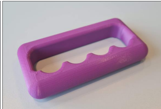
Figur 24 - 3D-print Håndtak 1.1, Foto: eget materiell
