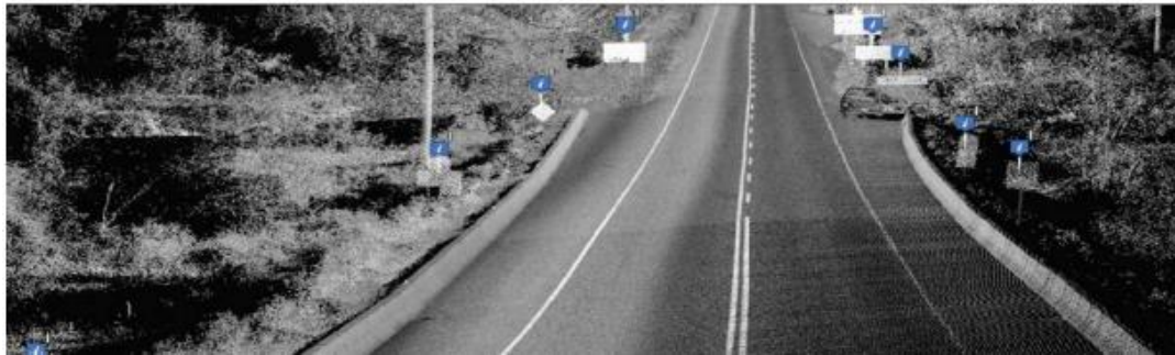
Figur 48 - Punktsky fra LiDarskanning i trafikkfart. Trafikkskiltene markeres automatisk av algoritmen (Malehmir et al., 2018).
