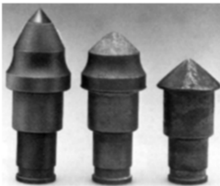
Figur 4.1: Perfekt slitasje på kutterenhet (Kotwica og Malkowski, 2019).
