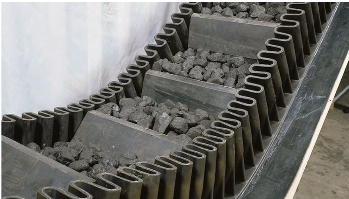
Figur 7.2: Eksempel på et vertikalt transportsystem som benyttes i sjakt. Større blokker kan ikke fraktes med transportsystemet.
