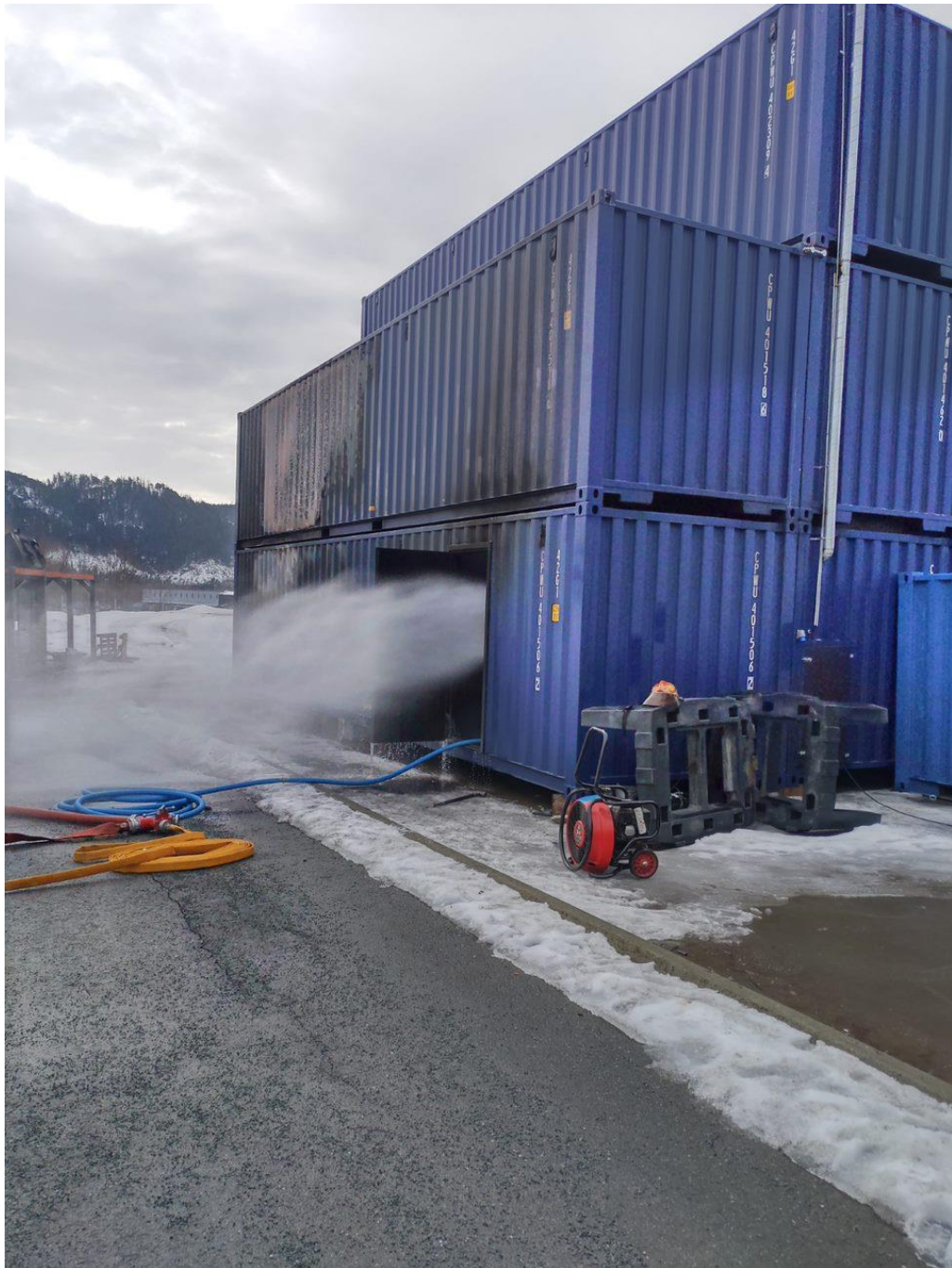
Figur C.3: Ventilering med strålerør ut inngang A (øvelse 1).
