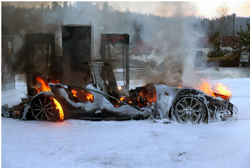
Figur 2.4: En Tesla Model S 2014-modell ble totalskadd etter at den tok fyr under lading på en hurtigladestasjon. Bilde: iGjerstad.no. Bildet er gjengitt med tillatelse fra iGjerstad.no.
