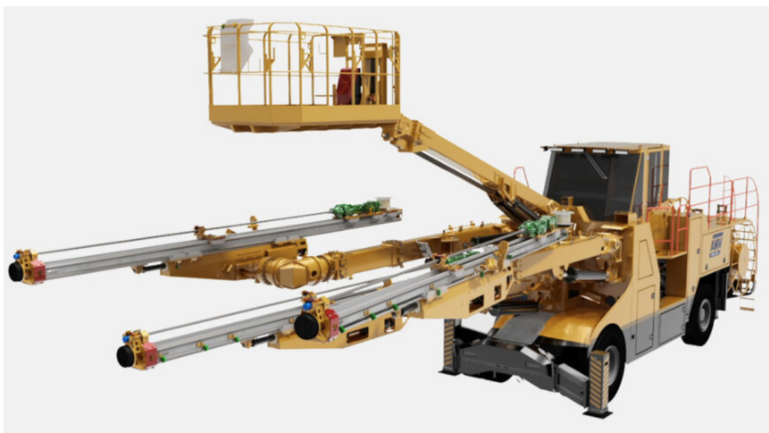
Figur 2.3: Illustrasjon av tunnelborerigg (illustrasjon hentet fra AMV sine nettsider)
