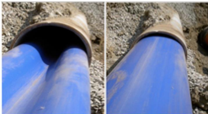
Figur 4: Sammenfoldet rør fra fabrikk før og etter trykksetting (VA/Miljø-blad 90, 2009)
