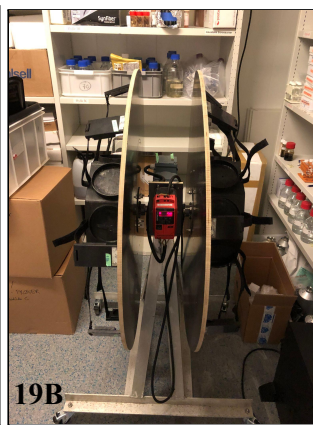
Figur 19A-B: Bildene viser karusellen som ble brukt i forsøket på alle prøvene med turbulensen “rotating”.
