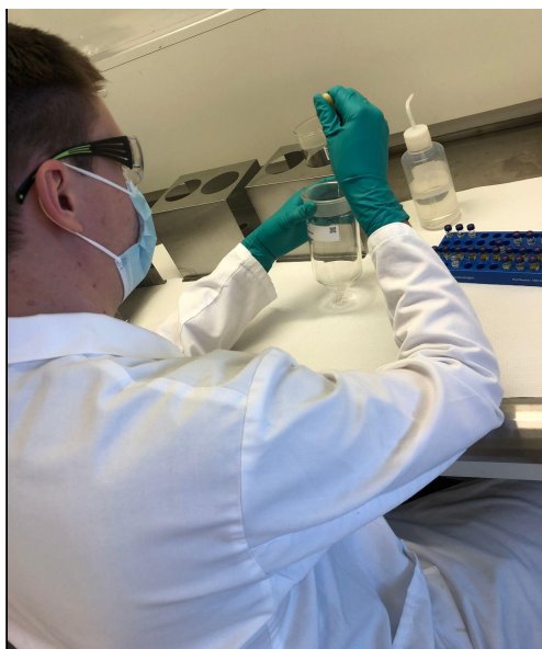
Figur 25A: Bildet viser et utsnitt av prosedyren. Her blir rørets vegger vasket med DCM.
