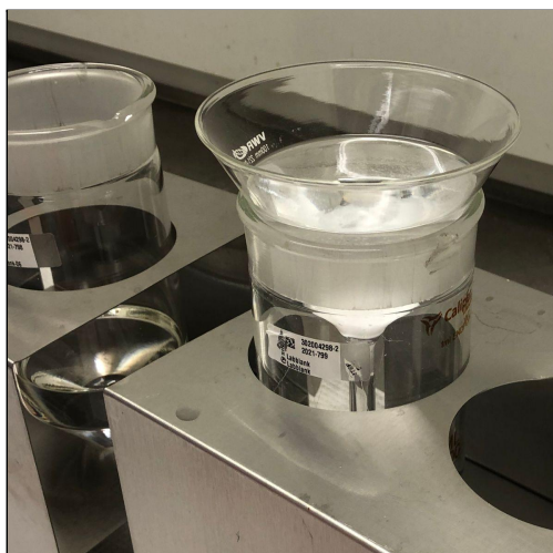
Figur 23B: Bildet viser hvordan ekstraktet ble filtrert gjennom Bilsomvatt og overført til TurboVap ® -rør.
