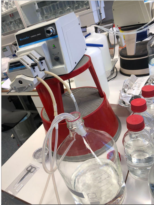
Figur 14A: Bildet viser oppsettet under sterilfilteringen med pumpe, rør og sterilfilter.
