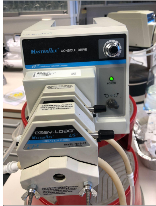
Figur 14B: Bildet viser den peristaltiske pumpen som ble brukt under forsøket.
