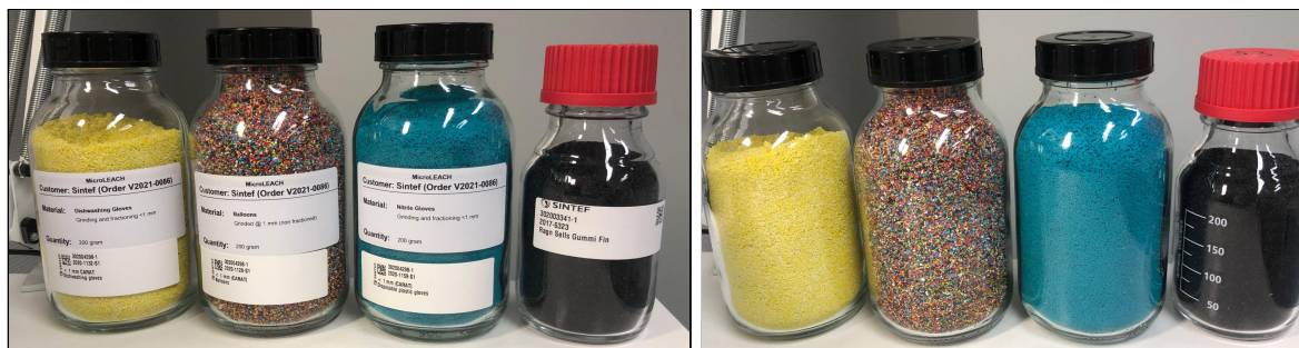
Figur 12A: Bildet viser materialene som ble brukt i forsøket på merkede beholdere. Fra venstre: DG, BAL, LG og CTR.
