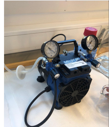
Figur 16C: Bildet viser Millipore ® -pumpen som ble brukt til filtrering.
