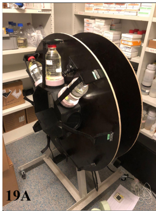
Figur 19A-B: Bildene viser karusellen som ble brukt i forsøket på alle prøvene med turbulensen “rotating”.
