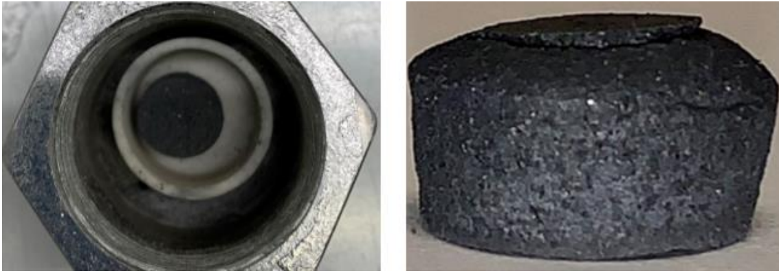
Figur 55 GFA etter karbonatisering ved 514°C. Fra venstre: FA i digel i reaktor og nærbilde av FA-klump dannet under forsøk.
