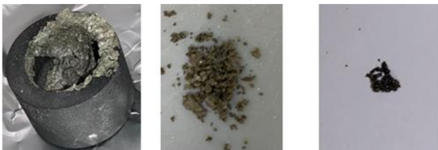
Figur 38 GFA etter reduksjon ved 1100°C. Fra venstre: Digel med restprodukt fra GFA, FA tatt fra digel og FA skrapet av fra lokket av reaktoren.
