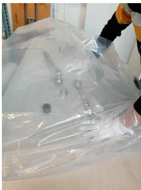
Figur 18 Hanskepose fylt med CO 2 .
