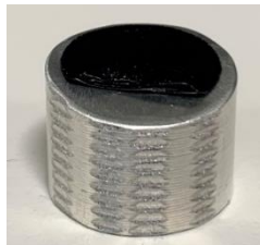
Figur 22 Prøveholder av Al med karbonteip.
