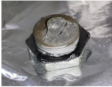
Figur 39 Lokket på reaktoren etter reduksjonsforsøk for GFA ved 1100°C.
