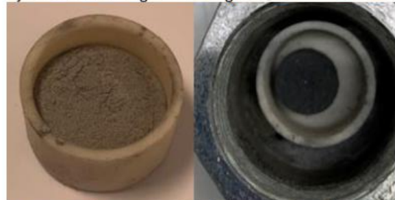
Figur 8 Bilde av ristovnsasken før (venstre) og etter (høyre) karbonatiseringsforsøk.
