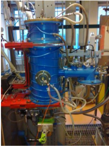
Figur 13 Til venstre er et bilde av TF2-ovnen som ble brukt i forsøkene (NTNU, 2015). Til høyre er en enkel skisse av ovnens virkemåte.
