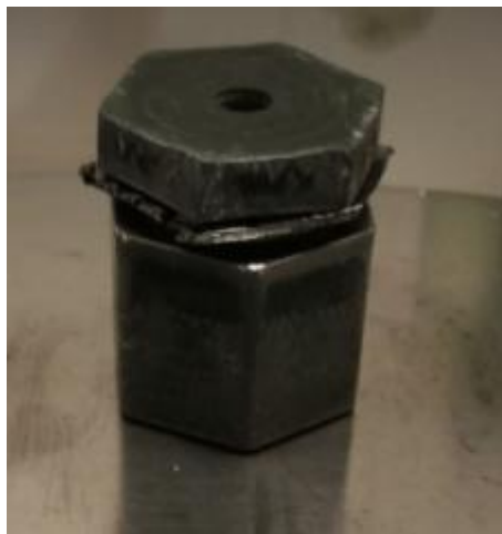
Figur 14 Reaktor med pakning som ble brukt under ovnsforsøk.
