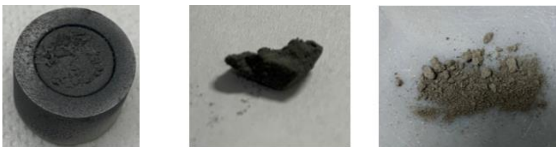
Figur 35 CFBA etter reduksjon ved 1100°C. Fra venstre: FA i digel, klump dannet under reduksjon og FA fra digel etter at klumper er tatt ut.
