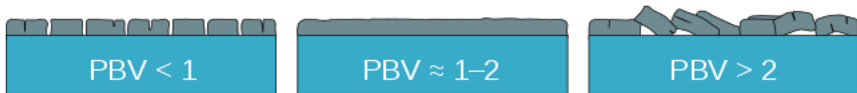
Figur 3 - En visualisering av oksidtilstander ved forskjellige Pilling-Bedworth forhold [22]. I figuren betyr PBV (Pilling-Bedworth Volume) det samme som PBR.
