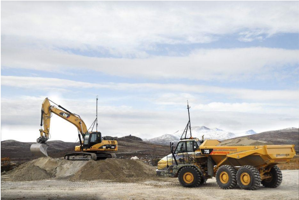
Figur 1 Bilde av de fjernstyrte maskinene, og toppen i bakgrunnen er der kommandosentralen stod (Vidar Heitkøtter, 2009).
