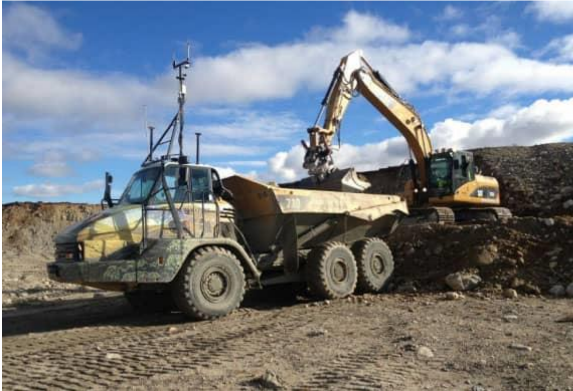
Figur 3 Dumper utstyrt med semi-autonom teknologi (Steer, 2021a)
