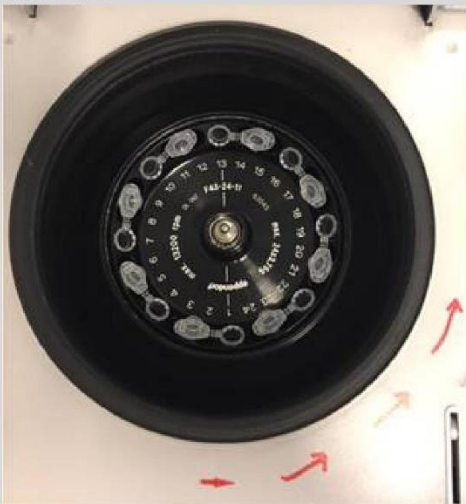
Bilde 2: Plassering av åpne rør: Sentrifugen roterer MOT klokka, se røde piler på bildet. Rørene skal plasseres slik at lokket henger som en «hale» bak røret. Hvis lokket ligger den andre veien, slites det lettere av.
