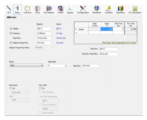
Figure C.2: GC inlet parameters
