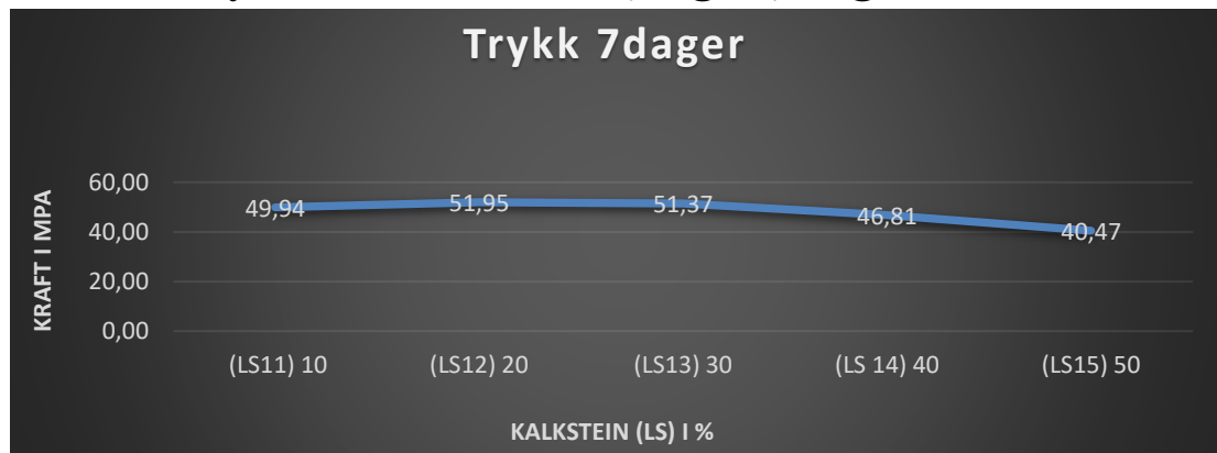
Figur 44 Trykk resultat etter 7 dager i forhold til kalkstein
