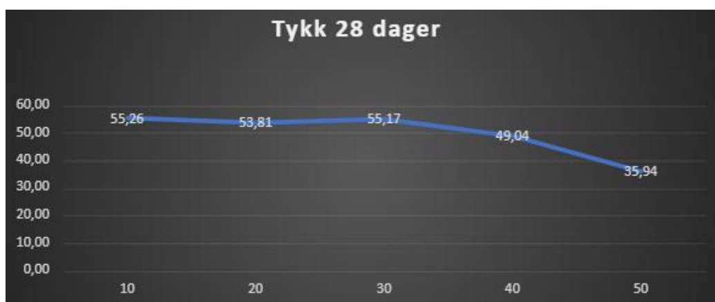
Figur 45 trykk resultat etter 28 dager i forhold til kalkstein
