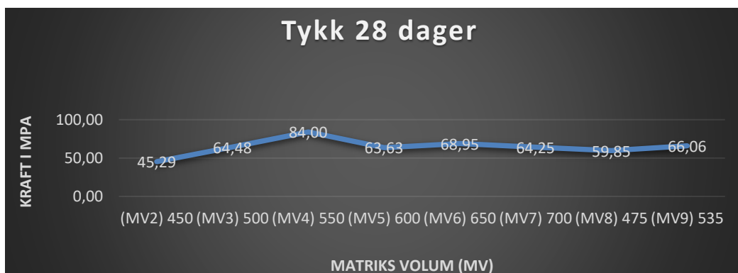
Figur 24 Trykk resultat etter 28 dager i MV
