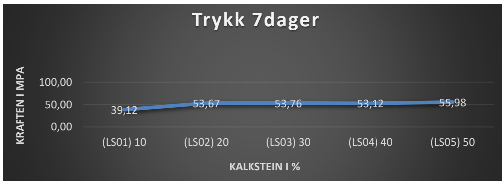
Figur 16 trykk resultat etter 7 dager I LS
