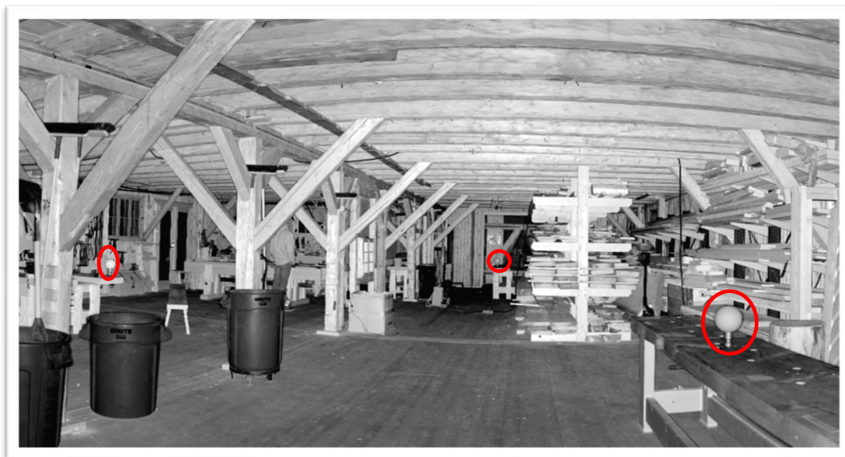
Figur 22 Fra skanneposisjon 3 i rom 15, referansekulene markert med rød sirkel. Skjermklipp fra SCENE
