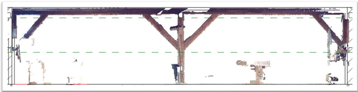
Figur 24 Tverrsnitt rom 15, plassering av avstivere. Hentet fra Revit, med punktsky
