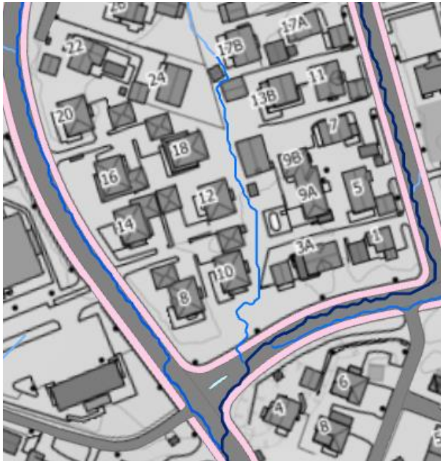
Figur 35: Utklipp fra modell i ArcGIS Pro. Beregnede dreneringslinjer følger veien i områder med oppbygd fortau.
