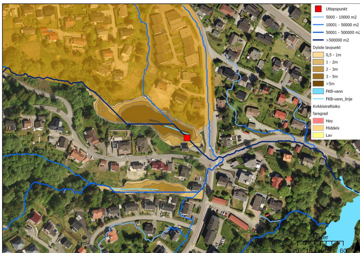
Figur 27: Mulig kritisk kulvert/bekkelukking på Strømmen. Kraftige vannmasser kan erodere i skråningen som grenser til kvikkleiresonen. Bakgrunnskart: Cachetjeneste fra Kartverket hentet fra Geonorge.no. FKB-data fra Geonorge.no.
