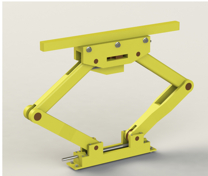
Figur 4.7: Modell av heisemekanismen i sin helhet
