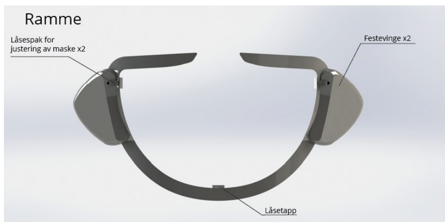
Figur 7: Ramme og dens komponenter. UM 2021
