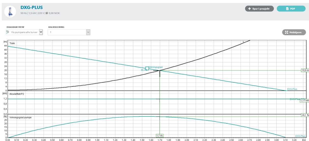
Figur 13: Skjermtutklipp av krysningpunkt mellom pumpekurve til DXG Plus og beregnet systemkurve. Se vedlegg 3 for større bilde.
