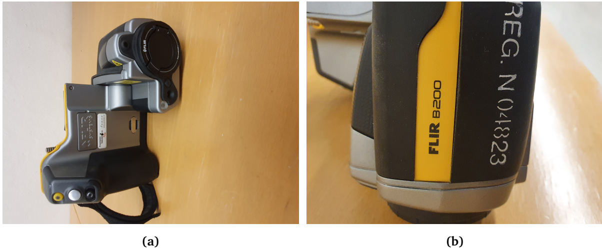
Figur 3.2: Det termiske kameraet som er brukt i oppgaven. Produsent: Flir. Modell: B200 Western, (Bilde tatt av Alf Dalby, Forskningsassistent, institutt for vareproduksjon og byggtknikk. Med tillatelse fra NTNU i Gjøvik).
