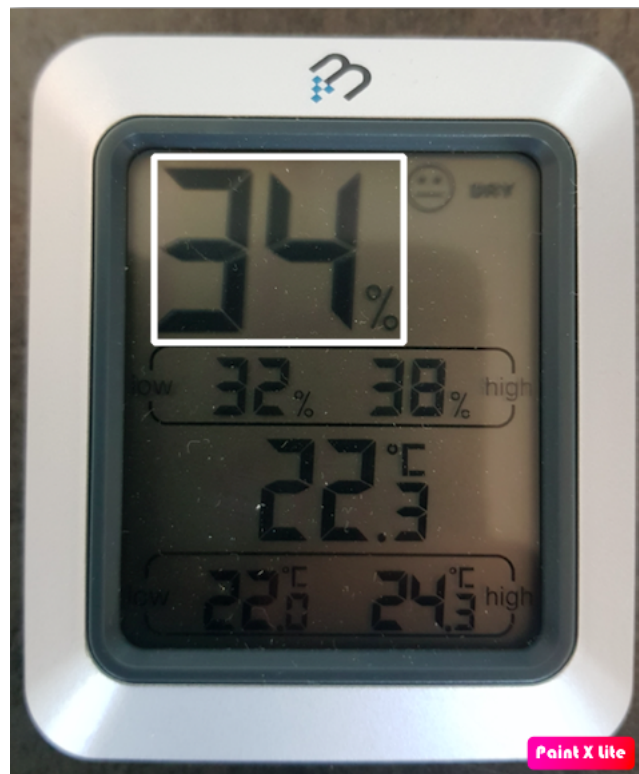
Figur 3.4: Hygrometer. Produsent: Biltema. Modell: 84-0802 Luftfuktigheten er markert med hvit rute.
