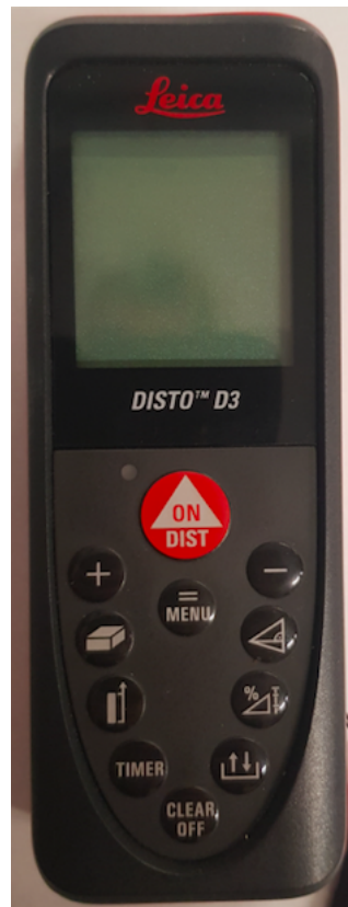
Figur 3.5: Avstandsmåler: Produsent: Leica, modell: DISTO D3. (Bilde tatt av Kristoffer Øverby, med tillatelse fra NTNU i Gjøvik)
