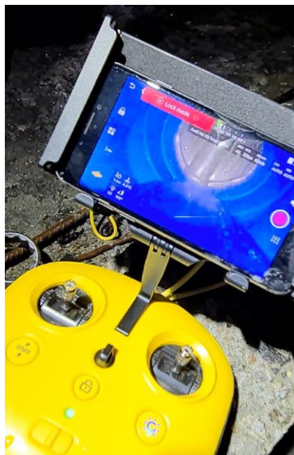
Figur 4.25: Controller viser bilde fra ROV når sluseventilen er i ferd med å åpnes
