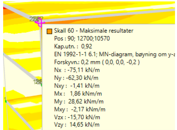
Figur 26 nordvest-hjørne med nødvendig armering
