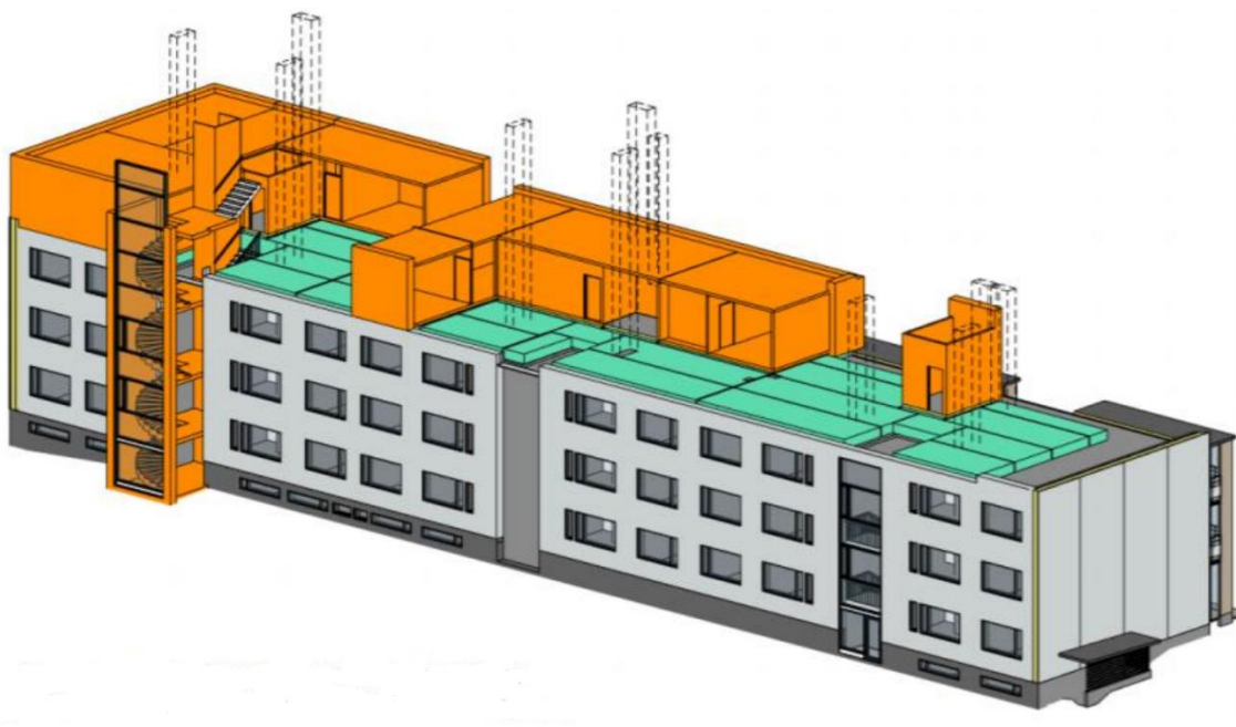
Figur 38 Prinsippkisse som illustrerer en mulig løsning ved bruk av moduler og en ytre heissjakt i Vestlia. Modulene plasseres over en lastfordelende ramme som fører laster ned i bærende vegger (Soikkeli et al., 2015)
