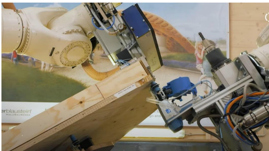
Figur 9 Komplekst 6 kantet takelement settes sammen av 2 roboter, bildet er hentet fra Youtube film (KUKA - Robots and automation, 2019)
