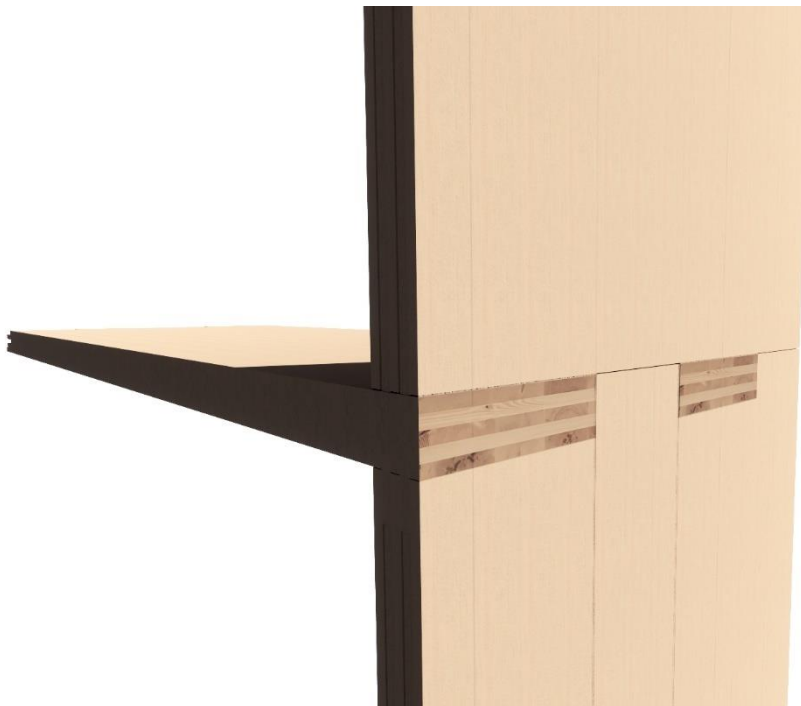
Figur 3: Illustrasjon av fingerskjøtløsningen
