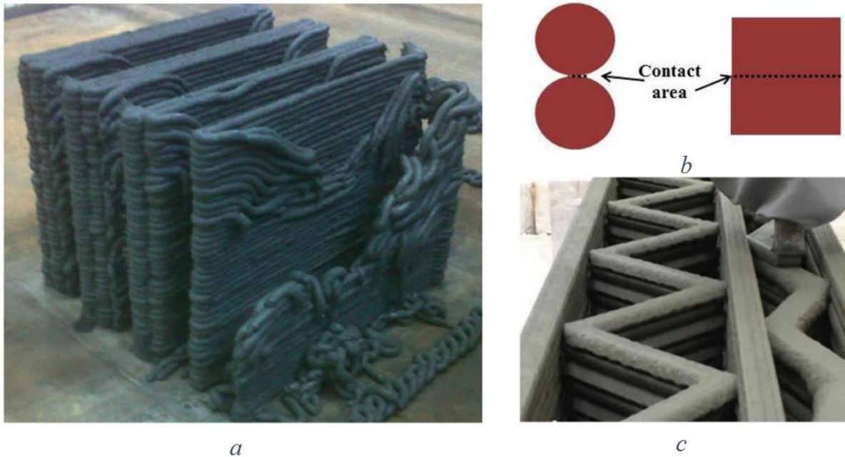
Figur 5: Printedysens utforming har betydning for materiallagenes kontaktflate og konstruksjonens stabilitet (Paul et al. , 2018).
