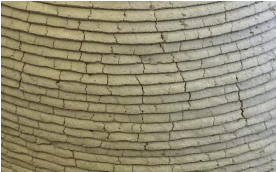
Figur 3: Eksempel på materialblanding som har krympet (De Schutter et al., 2018).
