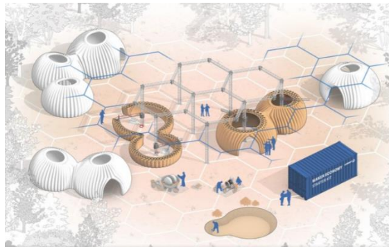
Figur 30: Printeren Crane WASP kan settes sammen av flere moduler
