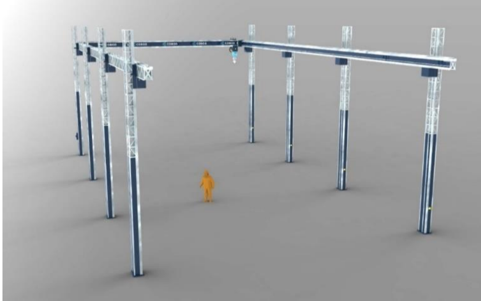
Figur 11 - Dette er gantryprinteren BOD2 fra danske COBOD. Printeren er 34,9 meter lang. (COBOD, 2020)
