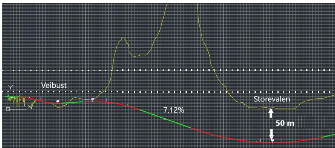
Figur 58. Utklipp av vertikalkurvaturen for alternativ 1, fra Veibust til Storevalen. Utklipp fra AutoCAD.
