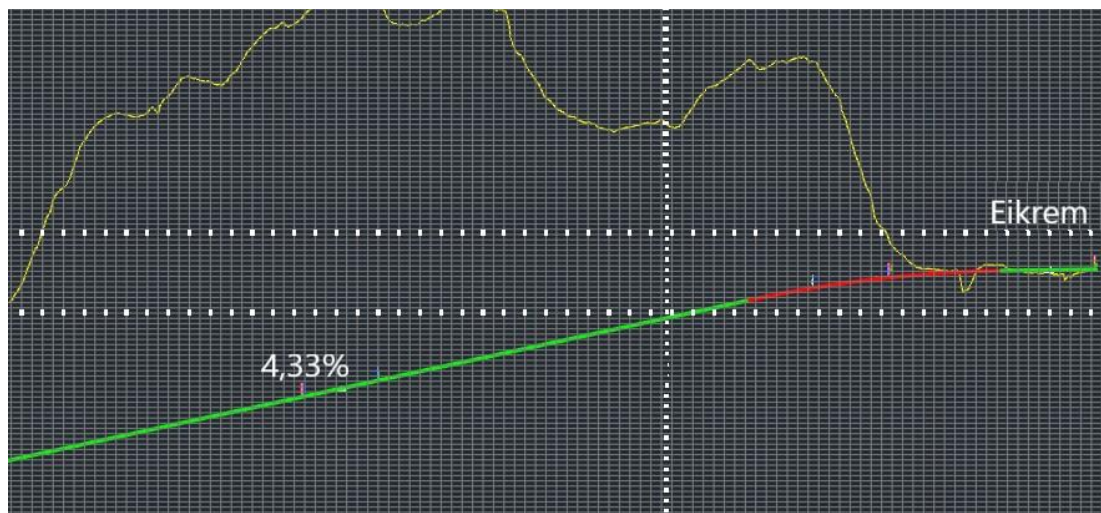
Figur 59. Utklipp av vertikalkurvaturen alternativ 1, fra etter Storevalen og til Eikrem. Utklipp fra AutoCAD.
