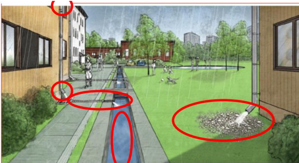
Figur 4-4 Illustrasjon av lokale overvannshåndteringer (77)
