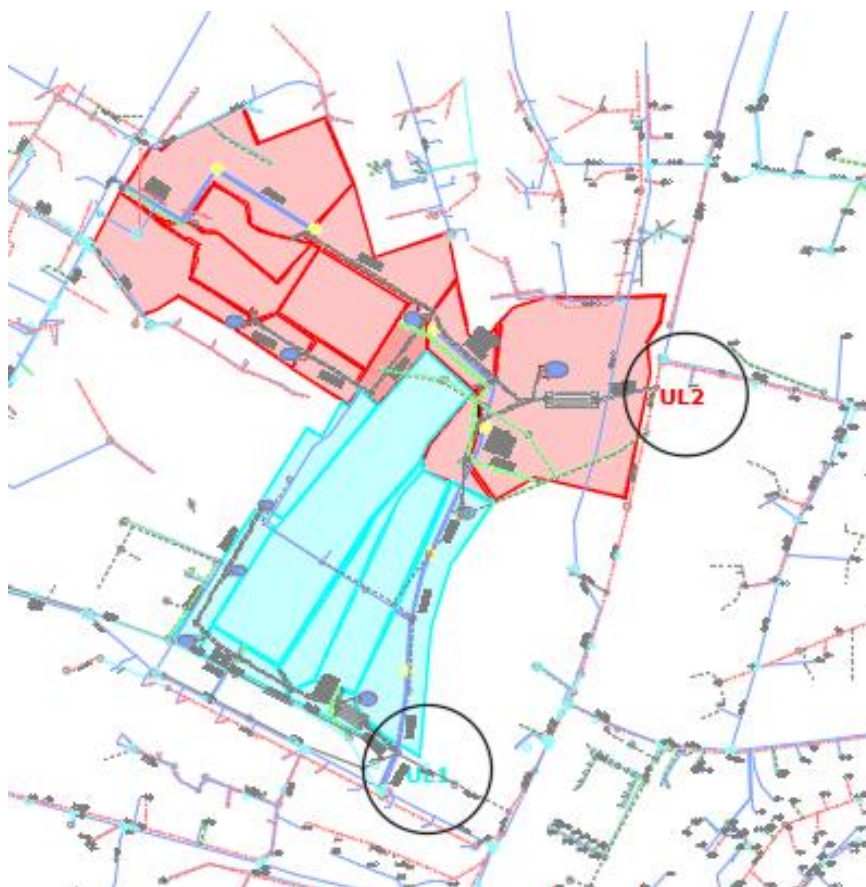
Figur 3-9 Reguleringsplan med eksisterende ledningsnett, de nye overvannsledningene og illustrasjon av utløp 1 og 2
