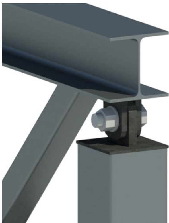
Figur 38: Bolteleddforbindelse mellom fagverksbjelke og søyle
