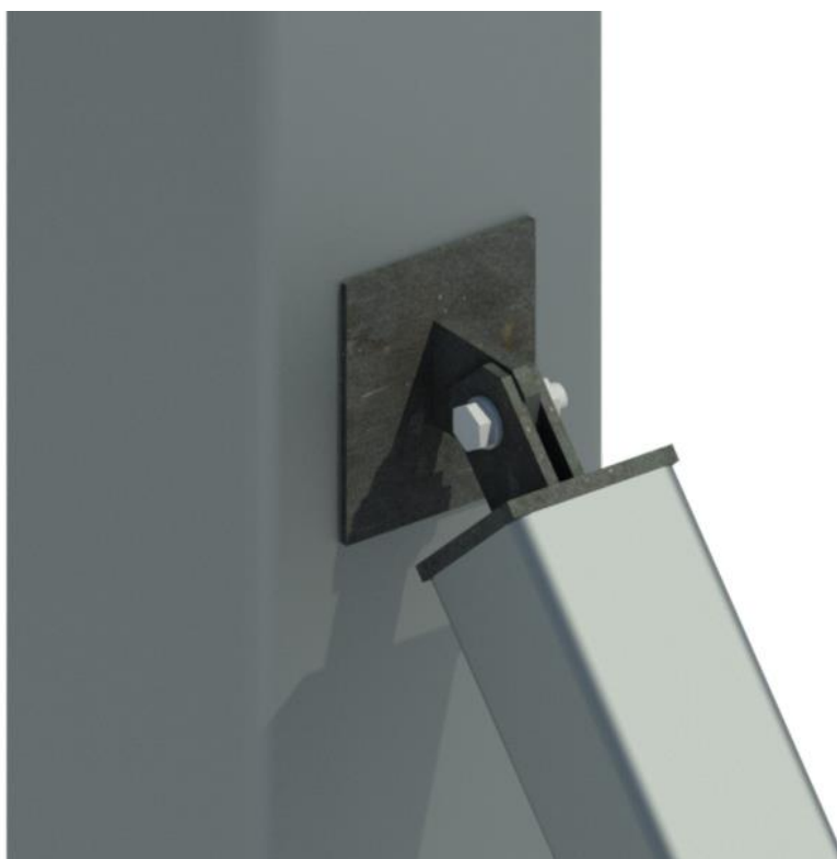
Figur 39: Bolteleddforbindelse mellom vindkryss og søyle
