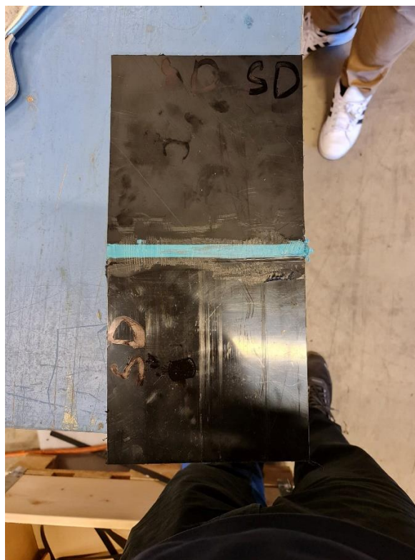
Figur 15: Større plater gir bedre sveis
