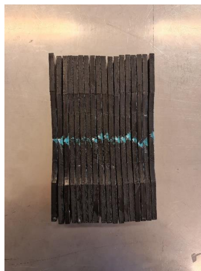
Figur 17: Ferdige prøvestaver, kan se at sveisen går gjennom
