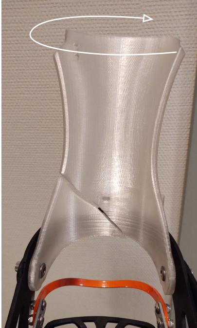
Highbacken printet i PETG knakk ikke lagvis.
