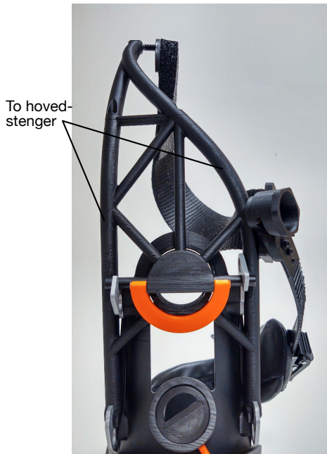
Sluttmodellen fra prosjektoppgaven hadde to hovedstenger for å være stiv nok til å ta opp kreftene fra brukeren.
