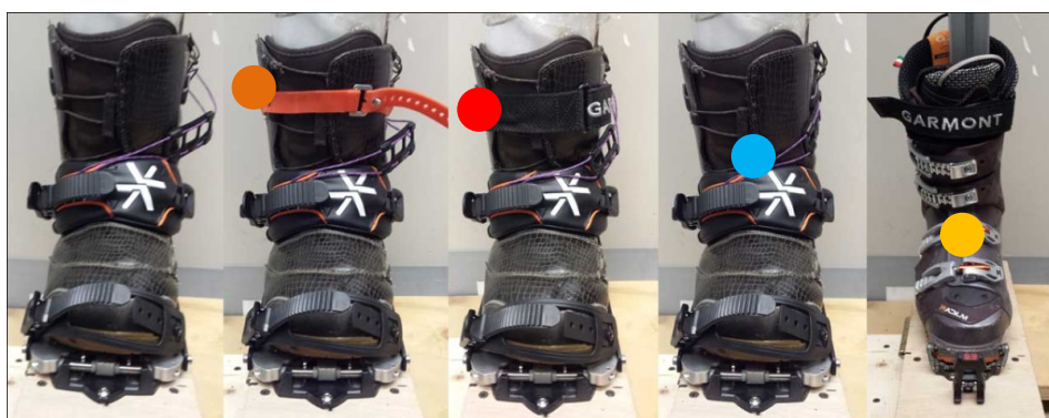
Ulike løsninger: Bare binding, skistropp, bårrelåsstropp, Flex-lock, hard boot. (Cunningham, 2015, foto: Karakoram)
