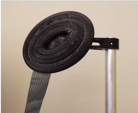
Stiv brakett med padding og innfelt stropp. Den av ubehagelig i kontakt med leggen.
