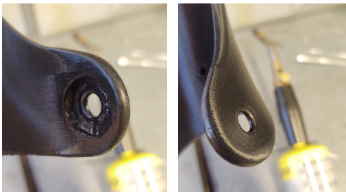
Forsterkning med metallskive og smelting.
