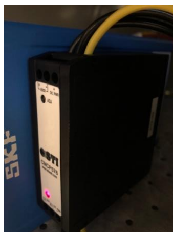
Figur 29: STI TTL converter montert ved siden av IMx-8 enheten (Meland,2020)
