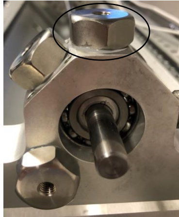
Figur 28: Tilkoblingspunkt montert på rotor rig i RAMS lab. (Meland, 2020)
