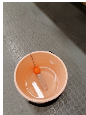
Figur 3.2: Måling av temperaturen i dusjvannet ved Dalgård.
