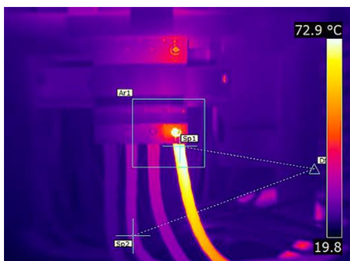
Figur 7: Illustrasjon av elektrotermografi (Hentet fra Elma Instruments, u.å.)
