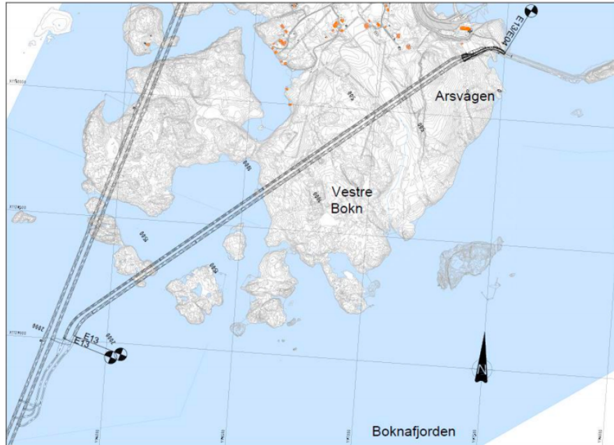
Figur 5.6: Sidetunnelen fra Arsvågen (Vik et al., 2017).
