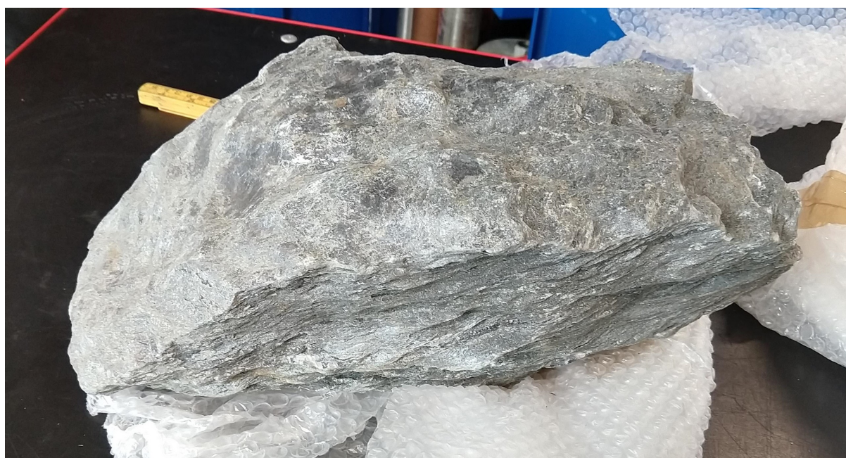
Figur 5.2: Fyllitt fra tverrslagstunnelen på Mekjarvik. Dimensjonene på blokken er ca. 40 cm x 15 cm x 12 cm.
