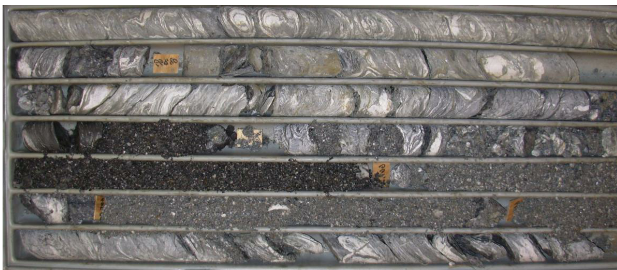
Figur 7.9: Kjerneboring Sauholmen hull BH01.10B viser oppknust og løsmasseaktig materiale ved dybde ca. 665.8-668 m. Bildet er hentet fra Saintot & Solli (2011).
