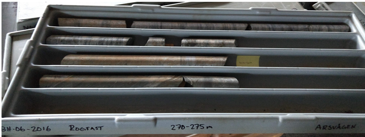
Figur 5.4: Foto av kjernebasse K-55, BH-06-2016, 270-275 m. Fra kassen er det tatt ut tre kjerner til enaksial trykktest og test av ultralydhastigheter.
