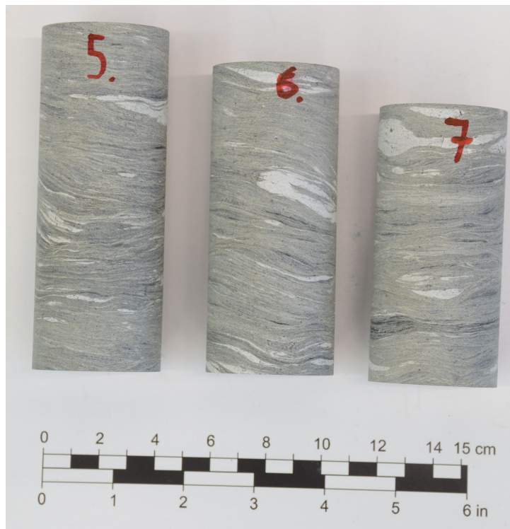
Figur 5.7: Ferdigpreparerte kjerneprøver av fyllitt. Dimensjonene til prøvene fremgår av tabell 5.2. Foto: Jon Runar Drotninghaug.
