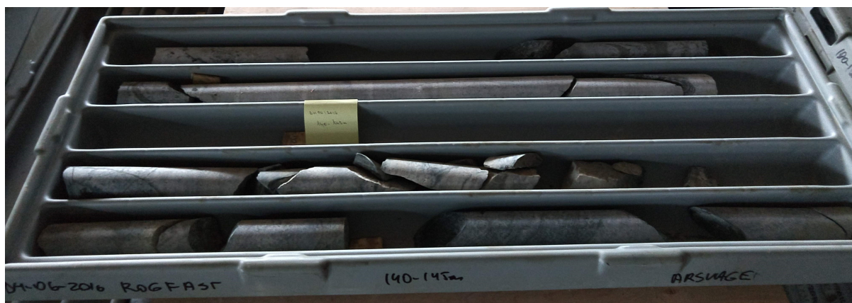
Figur 5.5: Foto av kjernebasse K-28, BH-06-2016, 270-275 m. Fra kassen er det tatt ut en kjerneprøve til enaksiell trykktest og test av ultralydhastigheter.
