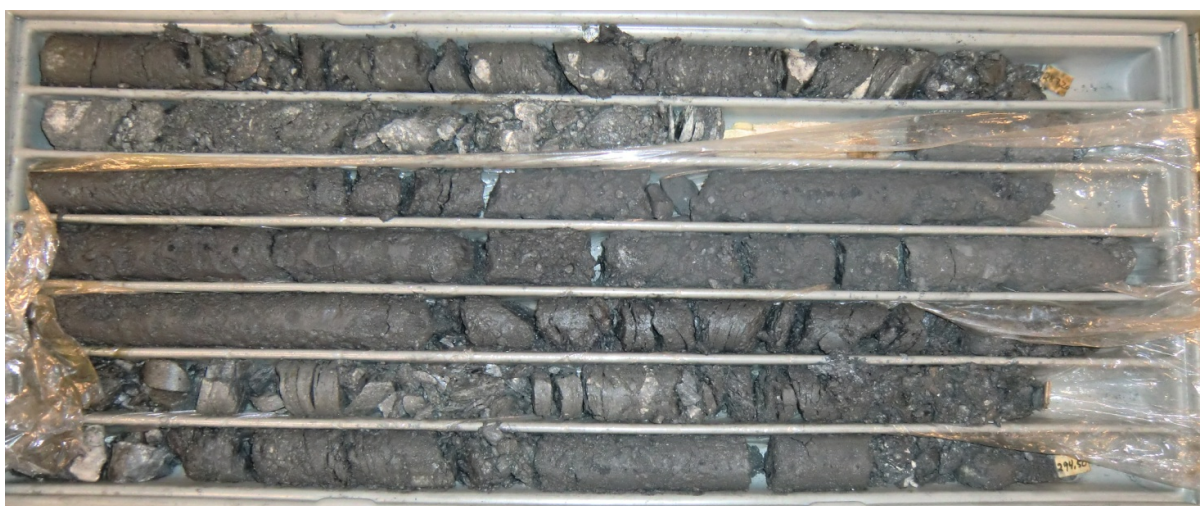
Figur 7.6: Kjerneboring Krågøy hull C ved dybde ca. 286-294 m. Bildet er hentet fra Holmøy et al. (2012).
