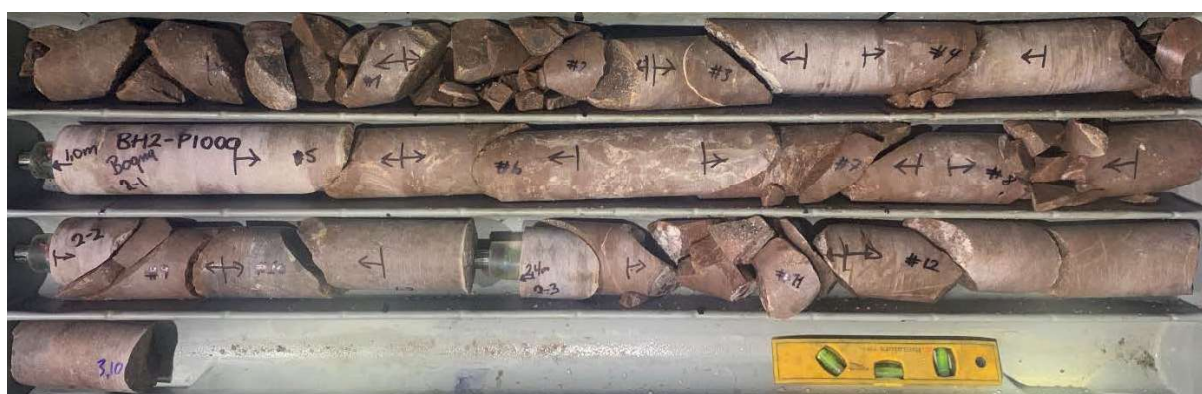
Figur 6.10: Avbildning av kjernematerialet til PEL1000 - BH2 (granittisk gneis). Indikasjon på tettere oppsprekking og/eller skade fra boring første 0.5 m. Ved 0.60 m og 2.60 m ble det observert et tydelig hvitt belegg, trolig utfelling av kalk.
