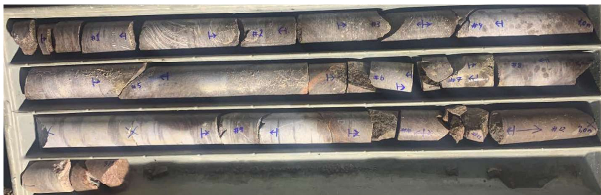
Figur 6.8: Avbildning av kjernematerialet til PEL1000 - BH1 (granittisk gneis). Antydning til sprengningsskade de første 20 cm.
