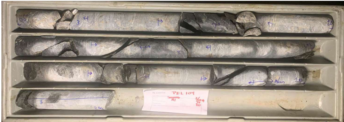
Figur 5.5: Borkjernematerialet etter boringen i SVORKMO-BH1. Materialet var relativt jevnt oppsprukket, lite skade fra boring.
