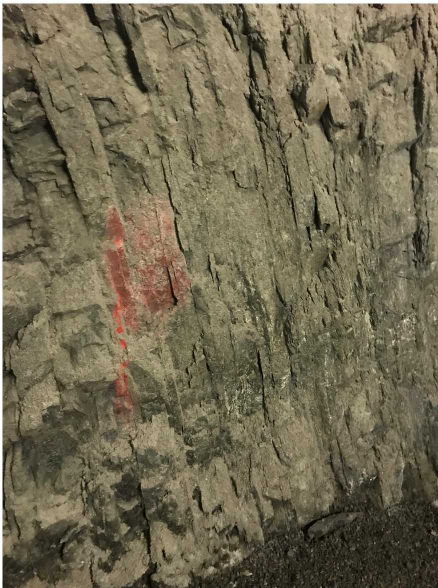
Figur 6.4: Bergmassen ved PEL850, bestående av en tett oppsprukket amfibolitt. Bildet er tatt ved nedre del av vegg. Midten av den røde markeringen ligger ca. 1 m over bakkenivå. Overflaten er noe påvirket av sprøytebetong.
