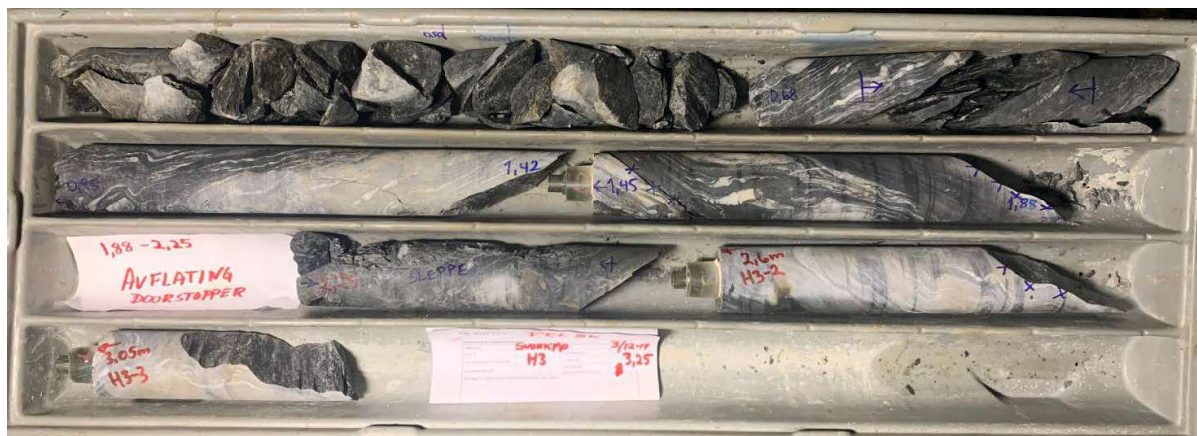
Figur 5.9: Bilde av materialet i kjerneboksen til Svorkmo-BH3. Skade fra boring første 0.7 m, deretter var kjernematerialet intakt. Plasseringen på de tre Doorstopperene er også vist.
