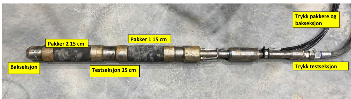
Figur 4.4: Dobbelpakker med injeksjonsslanger. Bakseksjonen, testseksjonen, pakker 1 og pakker 2 kunne trykkreguleres fra styrepanelet vist i fig 4.3.
