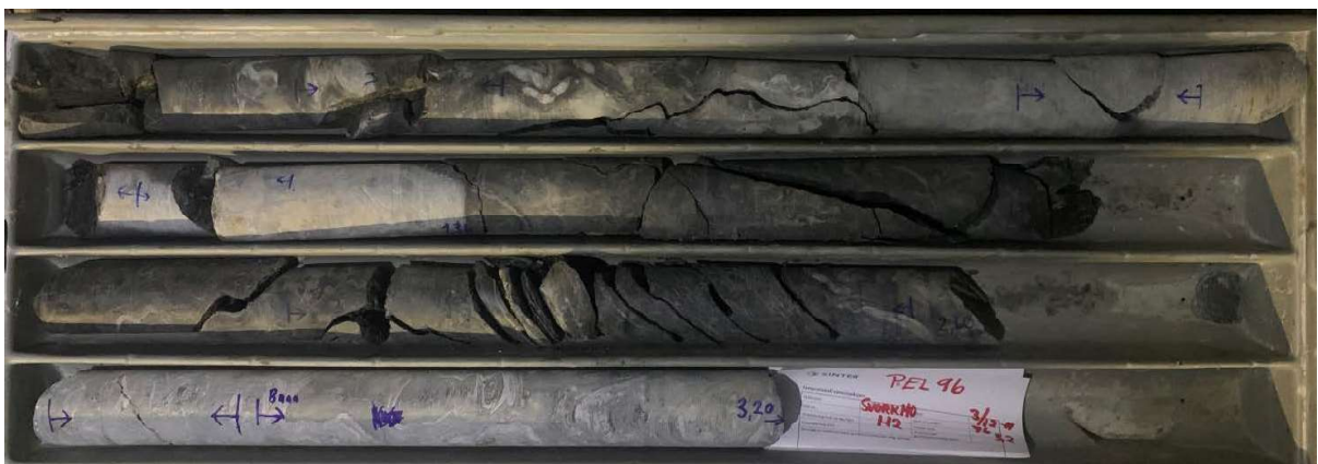
Figur 5.7: Borkjernematerialet etter boringen i SVORKMO-BH2. Materialet var en del oppsprukket langs foliasjonen, dannet fra boring og/eller avlastning av kjernen.
