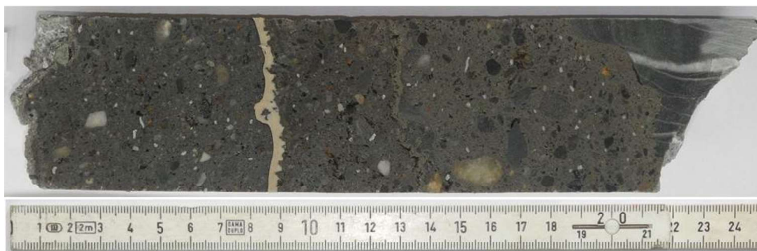
Figur 2.6: Et snitt av oppbygningen til tunnelkledning med bruk av vanntett sprøytbar membran. Til venstre er tunnelområdet, mens til høyre er bergmassen (Holter, 2014).
