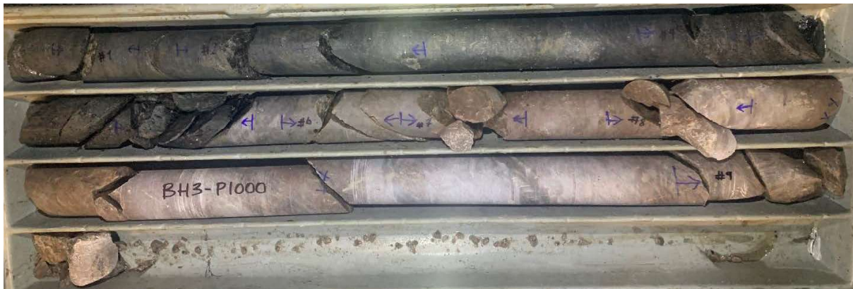
Figur 6.12: Avbildning av kjernematerialet til PEL1000 - BH3. Første 1.3 m bestod av amfibolittisk gneis, hvor resten var granittisk gneis.
