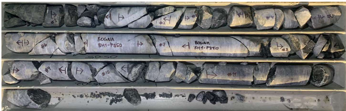
Figur 6.14: Bilde av materialet i kjernekasen til PEL850-BH1 (amfibolitt). Materialet var relativt tett oppsprukket langs hele kjernen, både av naturlige sprekker og skade etter boring.
