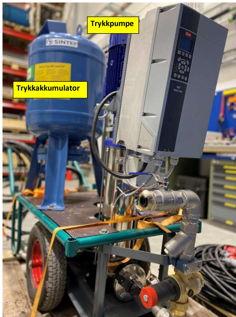
Figur 4.5: Pumpeautomat utstyrt med 80 l trykkakkumulator.
