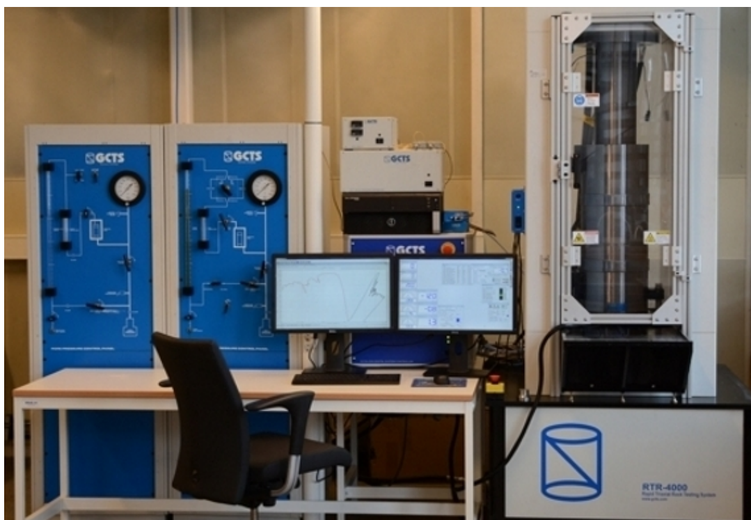
Figur 4.1: Avbildning av GCTS RTR-4000 hydraulisk bergpresse, for utføring av styrke- og deformabilitetstesting på kjerneprøver (IGP, 2020).
