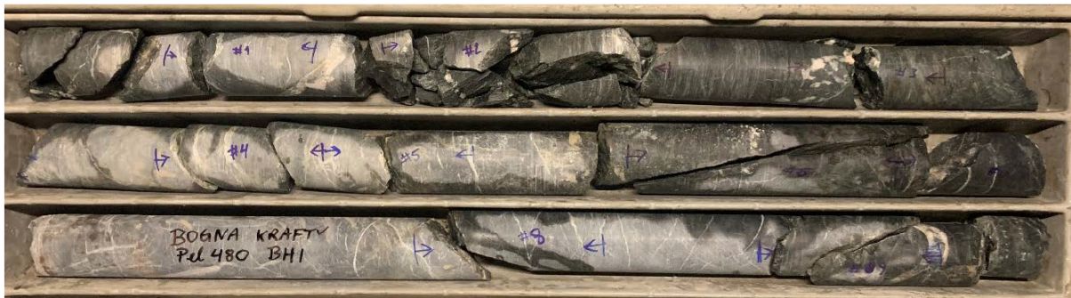
Figur 6.18: Bilde av materialet i kjerneboksen til PEL490 - BH1 (kalkspatmarmor). Antydning til sprengningsskade første 20 cm av borehullet.
