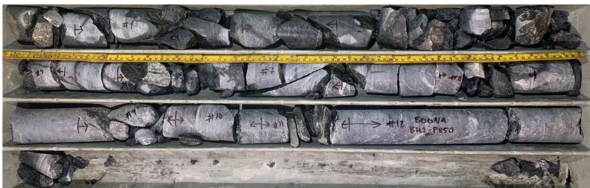
Figur 6.16: Bilde av materialet i kjernekasen til PEL850-BH2 (amfibolitt). Relativt mye skade etter boring, spesielt langs den første meteren.
