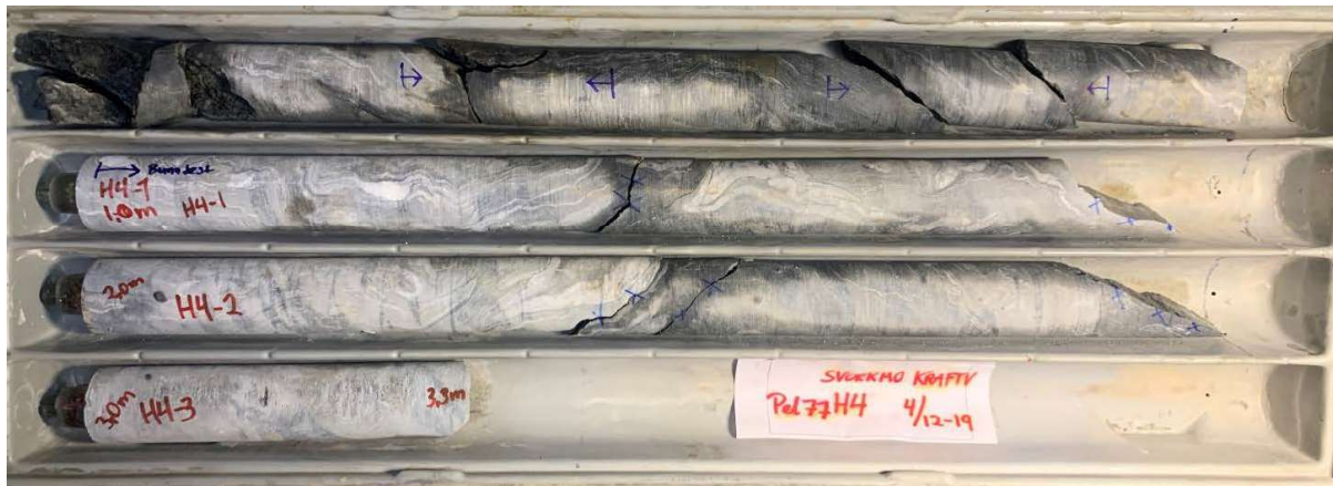
Figur 5.11: Bilde av materialet i kjerneboksen til Svorkmo-BH4. Noe oppsprekking fram til ca. 0.8 m, deretter var kjernematerialet fullstendig intakt.
